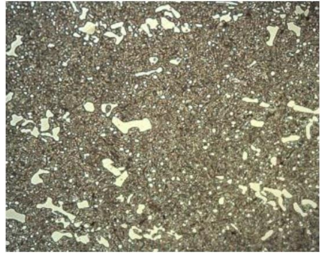
Şekil 1: Din 1.2436 çeliğine ait mikroyapı görüntüsü (500x)
