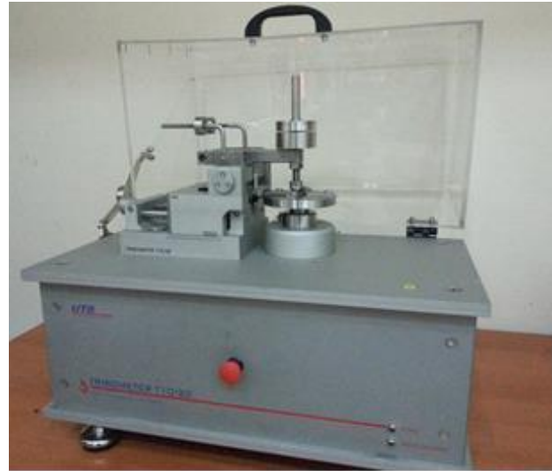
Şekil 1. Sürtünme ve aşınma deneylerinin gerçekleştirildiği tribolojik test sistemi (UTS Tribometer T10/20).
